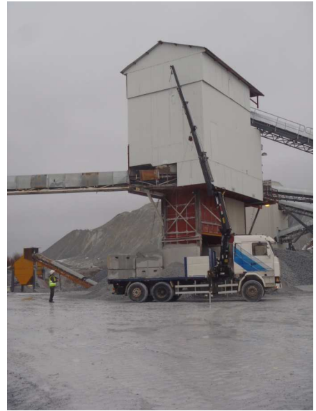
Bilde 2 – Bruk av kran for å måle lydnivå på fasade av siktehus 1
