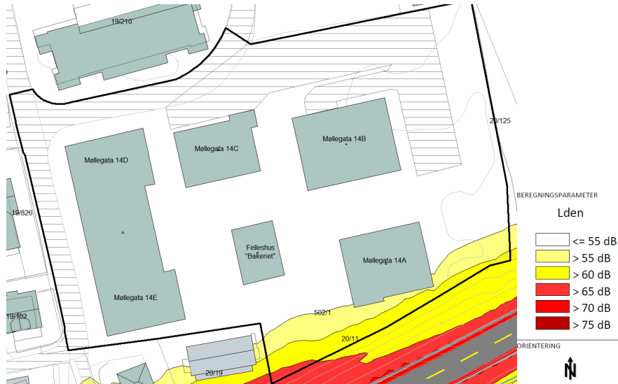
Figur 3 – Beregnet ekvivalent støynivå, L_{den} , fra veitrafikk i høyde for utendørs oppholdsareal 1,5 meter. Utklipp fra vedlagte tegning X001.
