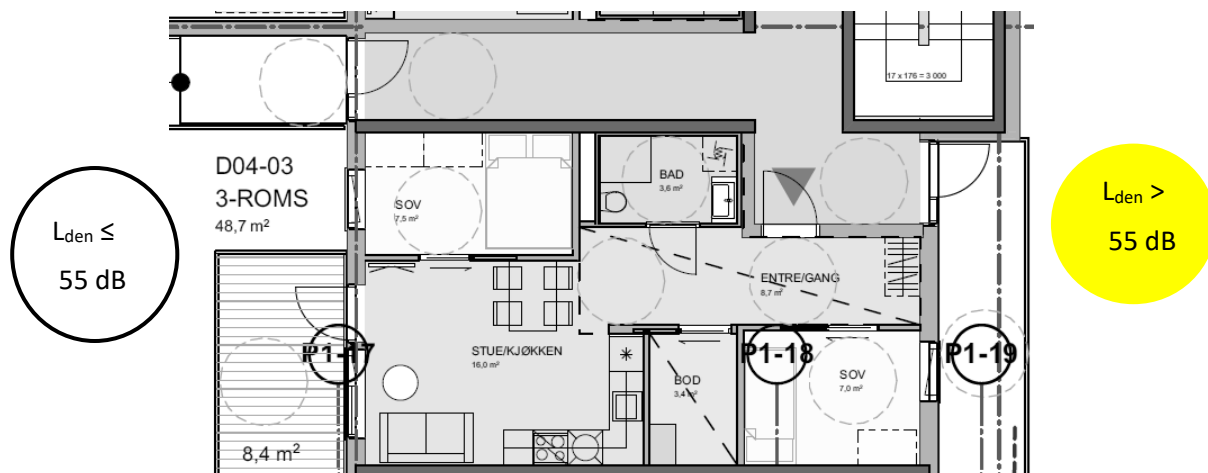
Figur 8 - Eksempel på planløsning som tilfredsstiller foreslåtte krav til støyutsatt enhet.
