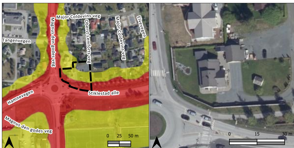
Figur 4.5: Til venstre: støysoner fra vegtrafikkstøy. Til høyre: Støyskjerm mot planområdet. Kilder: Statens vegvesen, Geovekst og kommunene, Kartverket.
