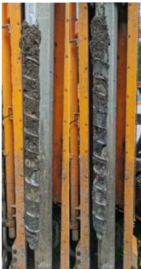
Figur 5: Løsmasser fra prøvepunkt M60, fra ventre 0-1 m og 1-2 m. Fyllmasser over oppblandet leire.
