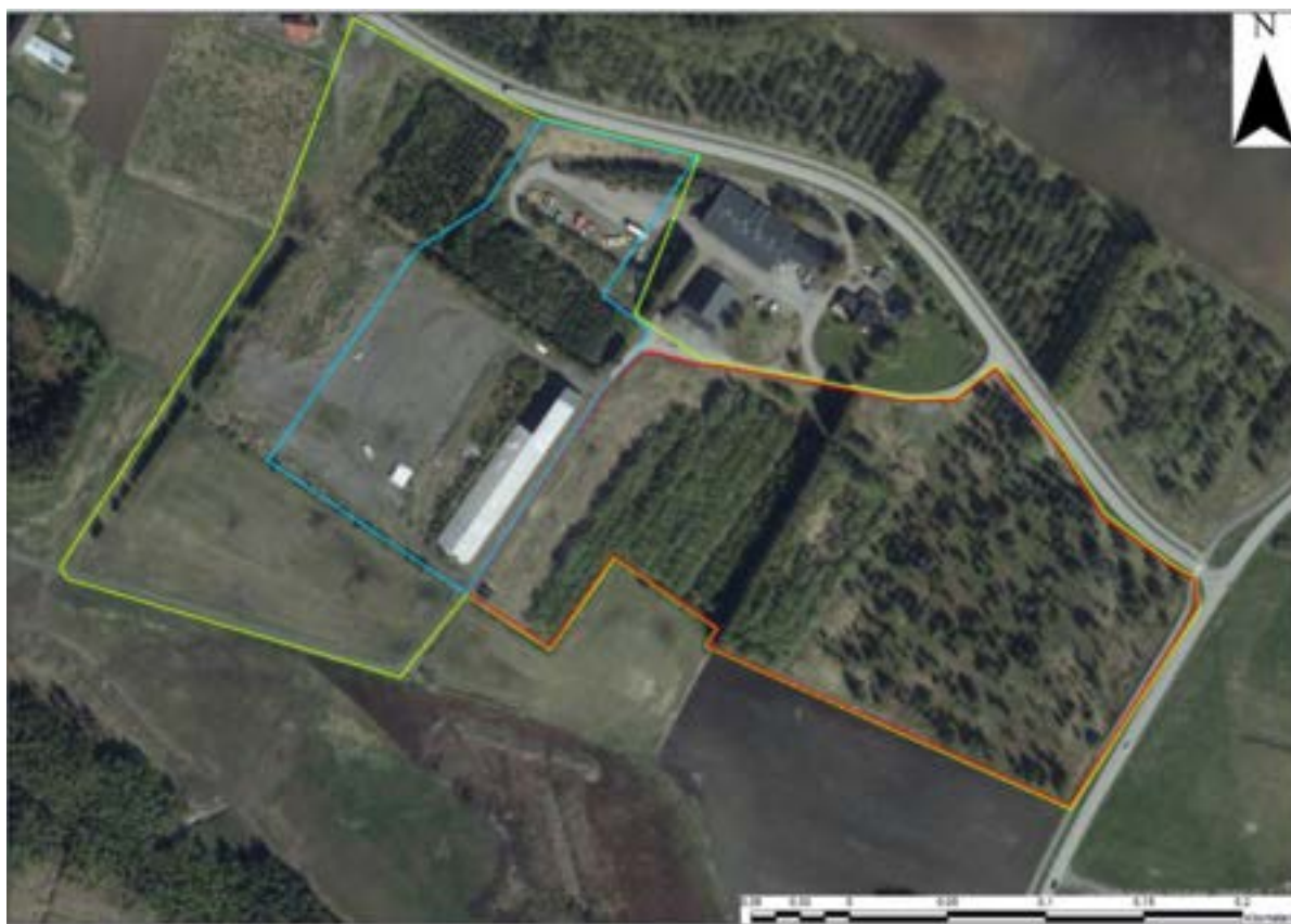
Figur 1-2: Oversikt over planområdet med omtrentlig utbredelse av innledende undersøkelser utført oktober og november 2018 (grønt omriss som overlapper delvis med rødt), omtrentlig utbredelse av miljøteknisk grunnundersøkelse utført i oktober 2019 (rødt omriss og området som er undersøkt i august 2020 (blått omriss). Kartkilde: Geodata AS
