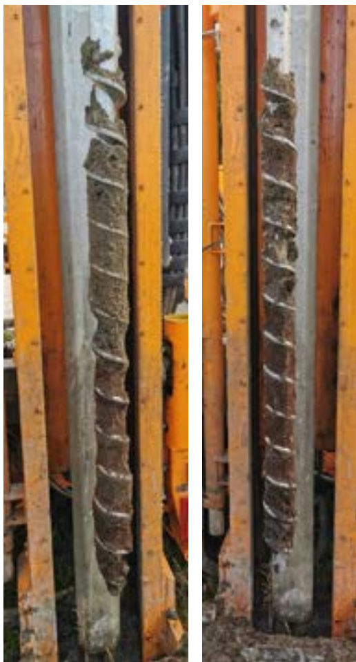
Figur 6: Løsmasser i prøvepunkt M40, fra venstre 0-1 m og 1-2 m, fyllmasser over torv.
