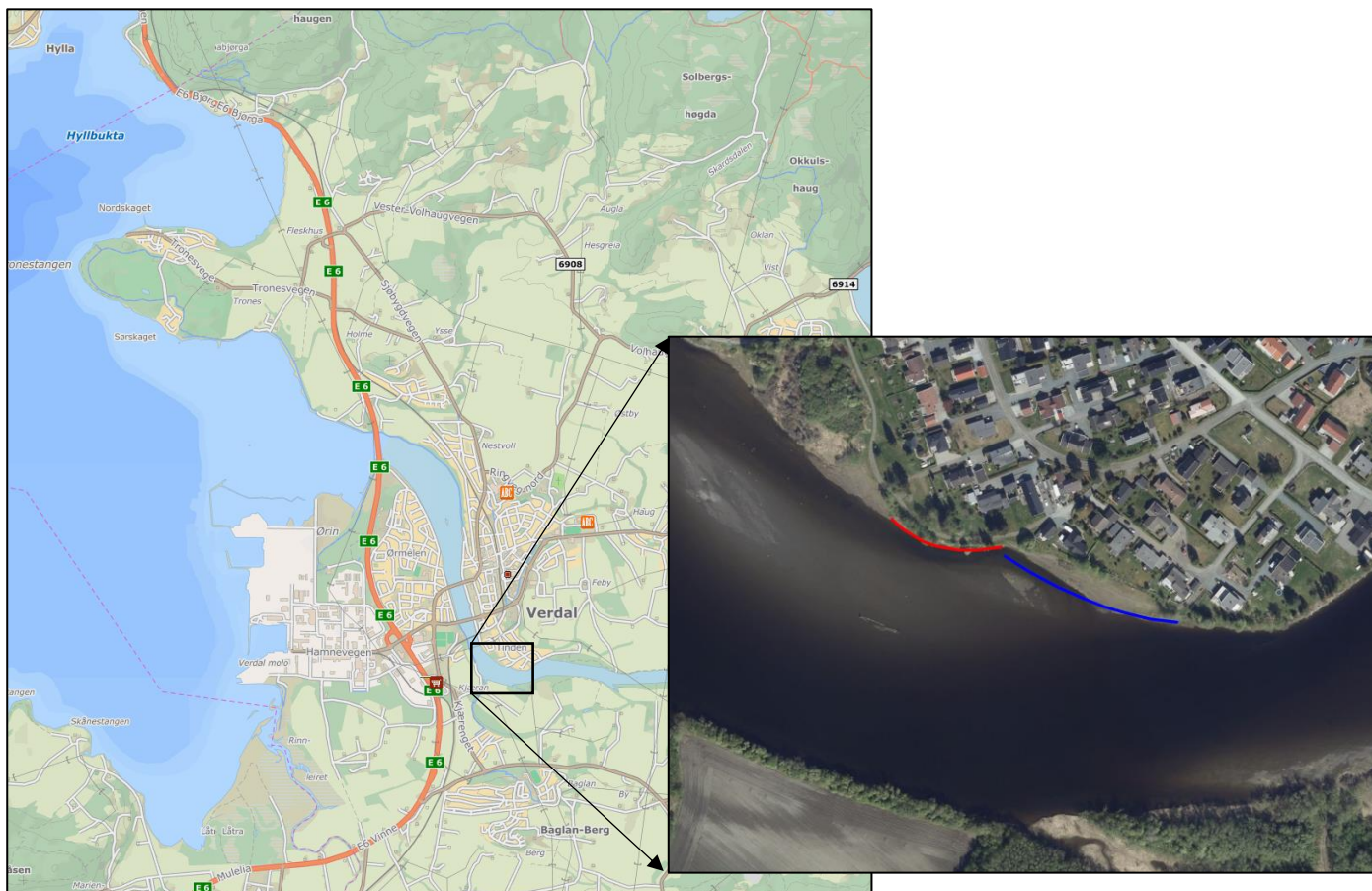
Figur 1 Oversiktskart. Rød linje ved detaljbildet viser hvor det skal lages nu erosjonssikring, og blå linje markerer området der det allerede er utført erosjonssikring.
