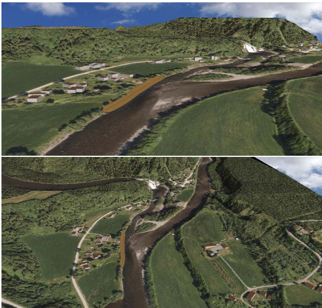
Figur 7: Utsnitt av terrengmodellen av sikringstiltaket.
