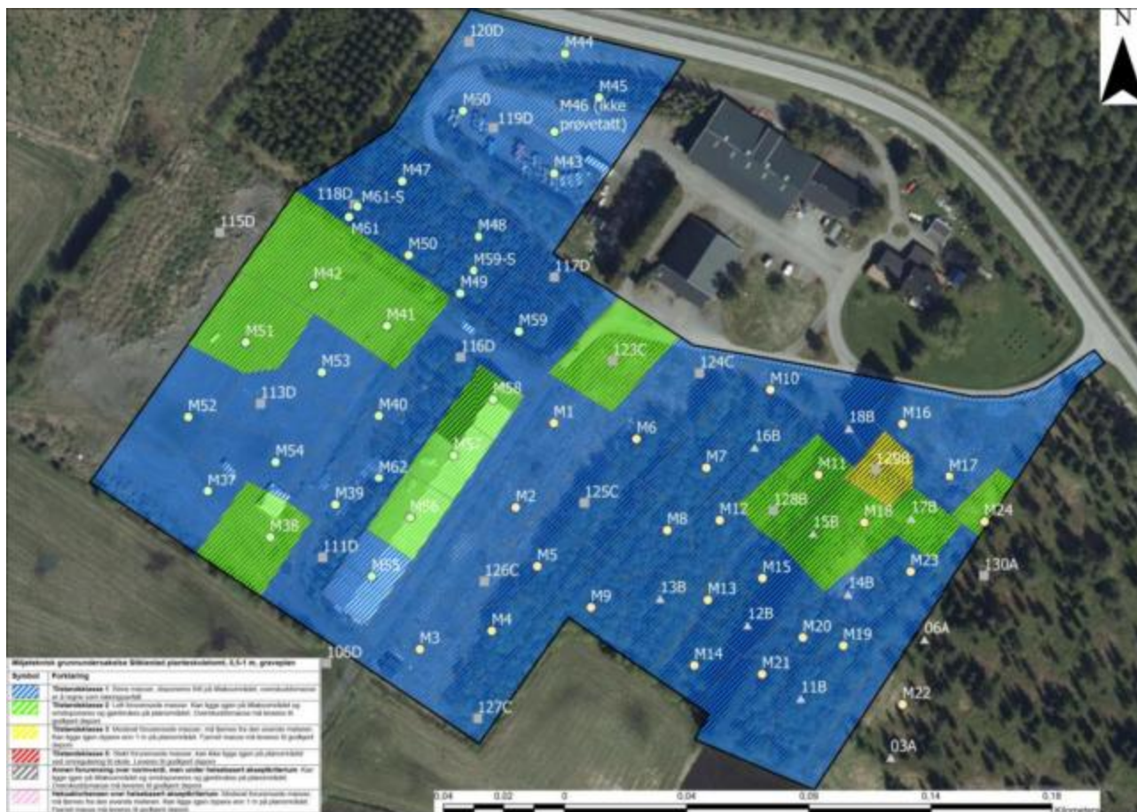
Figur 4. Resultater fra analyser vurdert opp mot tilstandsklasser og helsebasert akseptkriterium for 0,5-1 m under terreng. Gult område er forurensset med kobber i TK3, dette er ikke forenlig med omregulering til skole i den øverste meteren. Grønt område er forurensset med DDT i TK2 og kan ligge igjen ved omregulering til skole, men må leveres til deponi hvis massene fjernes fra tiltaksområdet. Blå områder er rene masser.
