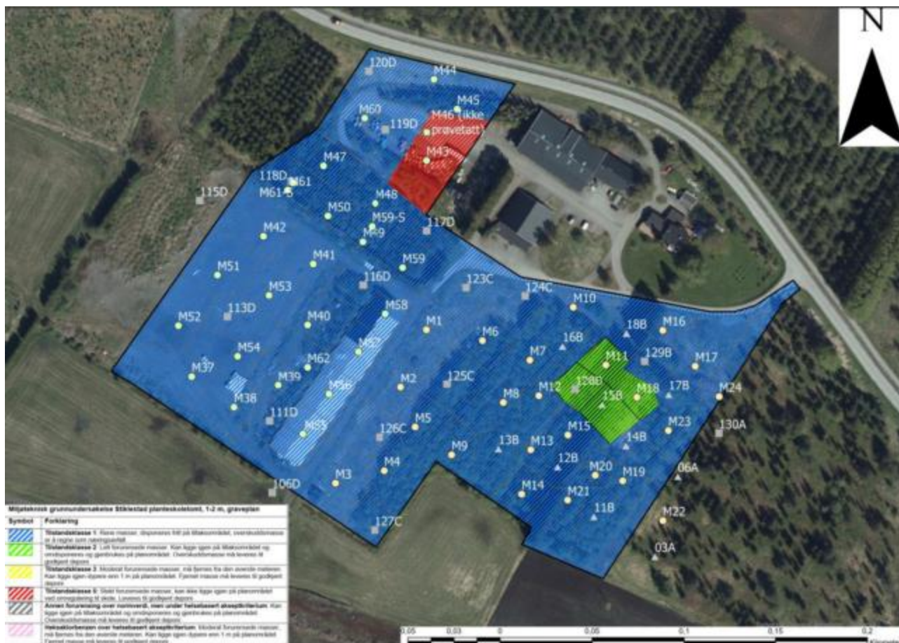
Figur 5. Resultater fra analyser vurdert opp mot tilstandsklasser og helsebasert akseptkriterium for 1-2 m under terreng. Rødt område er forurensset med PCB i TK5, dette er ikke forenlig med omregulering til skole. Grønt område er forurensset med DDT i TK2 og kan ligge igjen ved omregulering til skole, men må leveres til deponi hvis massene fjernes fra tiltaksområdet. Blå områder er rene masser.
