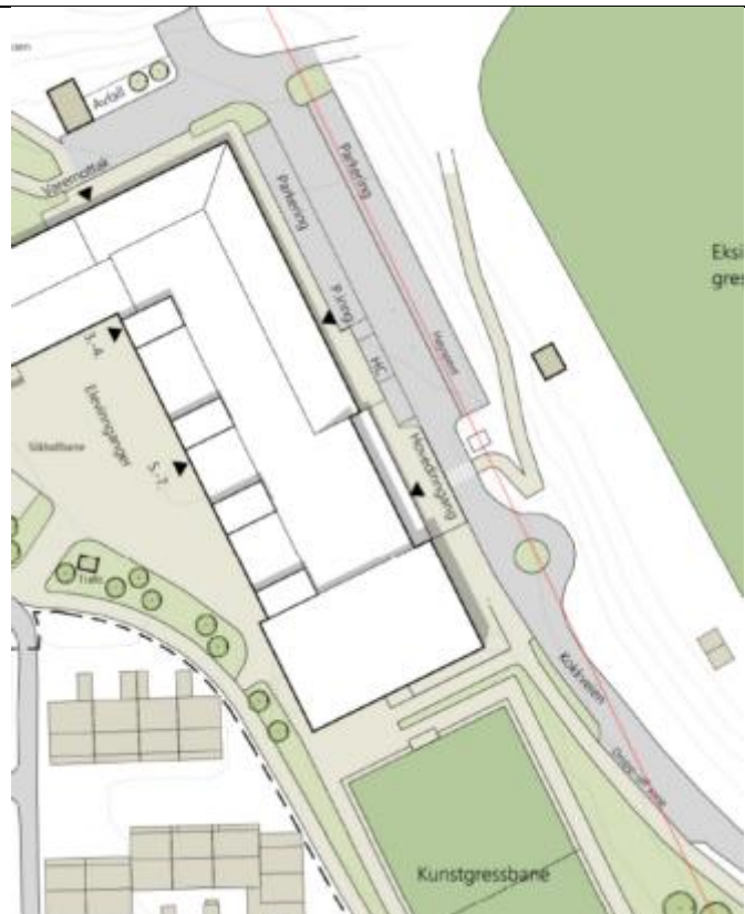
Figur 43 Utklipp av situasjonsplanen som viser hvordan gråarealene strammes opp med definerte arealer for gående/syklende, for parkering, for varelevering med snuhammer, , rundkjøring for personbiler, lomme for avsetning av passasjerer, gangfelt for atkomst til idrettsbanen, mm.
