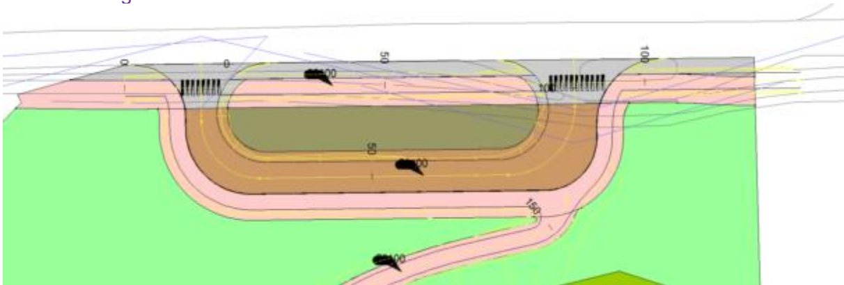
Figur 39 Illustrasjon som viser geometrien fra veiprojektet for busslomme sett sammen med foreslåtte arealformål og veilinjier i kartgrunnlaget.
