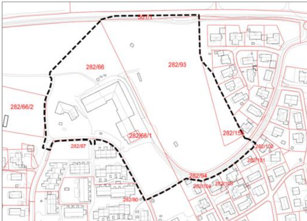
Figur 7 Kartutsnitt med eiendomsgrensar og gbnr for eiendommer som helt eller delvis ligger innanfor forslag til planavgrensning vist med sort stipling.
