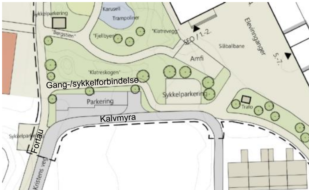
Figur 44 Utklipp fra situasjonsplanen som viser ny situasjon med oppstramming av gråarealene ved Kristens veg og parkering ved Kalvmyra, med fortau, sammenhengende gang-/sykkelforbindelse, rabatt som definerer parkeringsarealer, mv.
