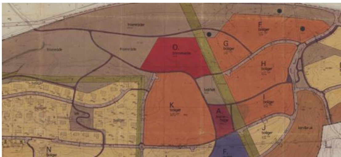
Reguleringsplan fra 1974 (planident 1974004), opphevet i 2017, viser 1-2 kjøreadkomster til skoletomta. Traséer med mørk brun farge er gangveger, ikke kjøreveger.
